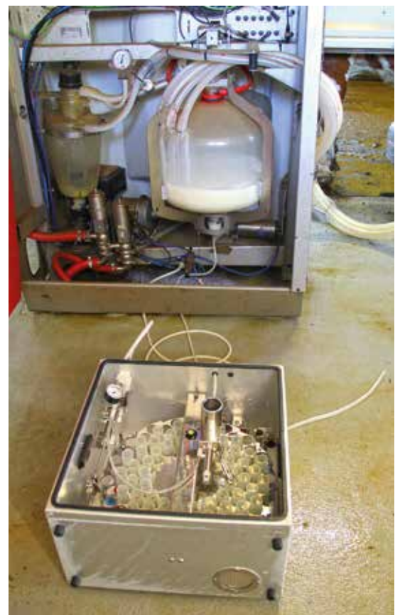
Probenahmegerät Ori-Collector bei der Arbeit
